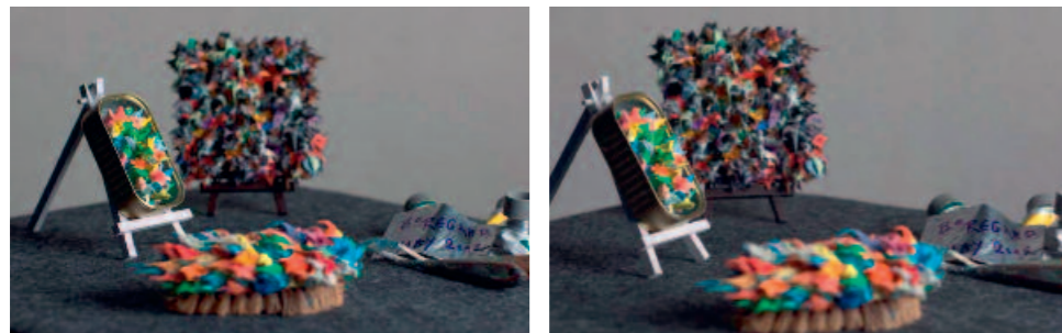
ABB. 23 Vergleich ARRI Alexa mit Zeiss UltraPrime (links) und Bausch & Lomb (rechts), diesmal wurde die rechte Aufnahme unter Berücksichtigung der spektralen Transmission des Bausch & Lomb profiliert
