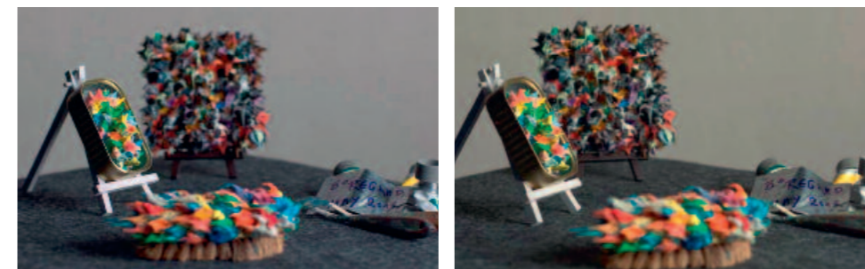
ABB. 22 Vergleich ARRI Alexa mit Zeiss UltraPrime (links) und Bausch & Lomb (rechts), beide mit gleicher Profilierung
