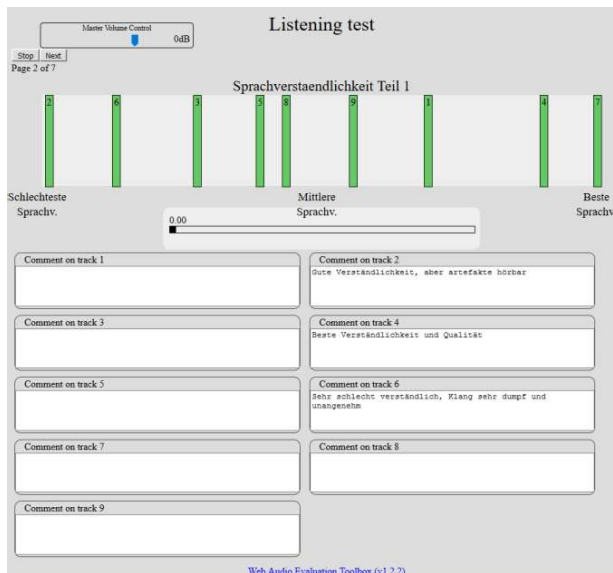
Abb. 4: einachsiges Hörversuchsinterface mit dem Web Audio Evaluation Tool: Jeder der grünen Balken repräsentiert eine auf der Skala zu positionierende Sprachdatei. Weitere Auffälligkeiten können anhand der Kommentarfelder weitergegeben werden.
