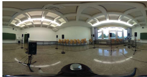
Abb. 2: 360°-Aufnahme des Genelec 1029A [11]-Lautsprechersets der virtuellen Konferenz: Die Raummaßen betragen 8,3x8,2x3,8m, die RT60 2,31s im Bereich von 500-1000Hz 2,31s (leerer und akustisch unbehandelter Raum).
