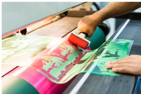
Abbildung 5: Montage einer Flexodruckplatte
