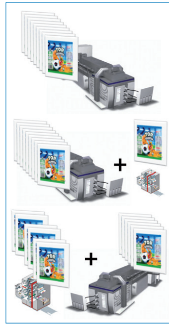
Von oben nach unten: Heute: Dominanz der konventionellen Druckverfahren Morgen: Der Digitaldrucker kommt ergänzend hinzu Übermorgen: Der Digitaldruck bedient Klein-Auflagen, der Flexodruck fertigt die verbleibenden größeren Auflagen (Drucken mit fester Farbpalette: CMYKRGB)
