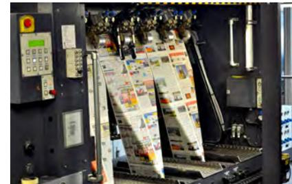
Interessant war unter anderem auch das Längsteilen der Bahn, sowie das Falzen im Trichterfalz. Zu sehen war außerdem das fertig gefalzte und beschnittene Produkt in der Auslage im ersten Stock, von der die Mitarbeiter des CTP-Labors die Qualitätsanalyse stichprobenweise durchführten.
