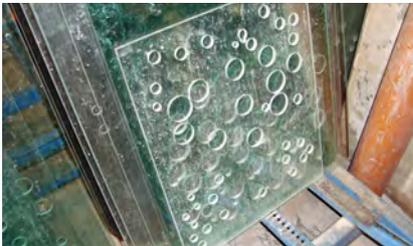
noch vor der Veredelung. Nach der Veredelung ist das Bohren nicht mehr möglich. Zusätzlich werden auch Sicherheitsgläser hergestellt, die einschlägigen Normen entsprechen müssen. Deshalb werden bei Bischoff Glastechnik standardisierte Versuche durchgeführt, wie beispielsweise der Falltest. Das Sicher-
