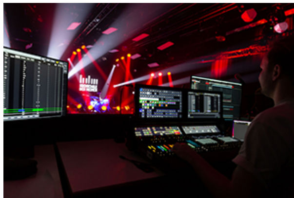
In der Lichtregie werden IP-basierte Pulte genutzt (Foto: Florian Müller)
