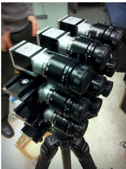
*Abb. 14: Fraunhofer IIS Lightfield-Array des Testdrehs November 2014 mit 3x3 Basler-Kameras*
