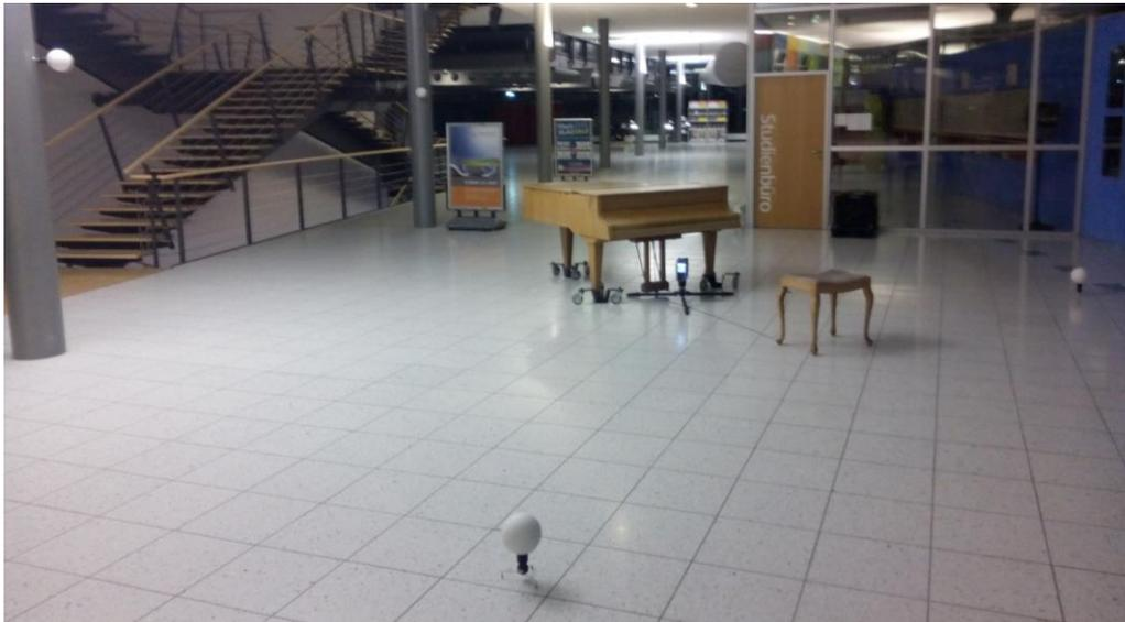
Abbildung 17: Beispielanordnung von sphärischen Targets bei einem Objekt-Scan
