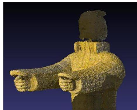
Abbildung 55: Fehlerhafte Triangulation (BPA)
