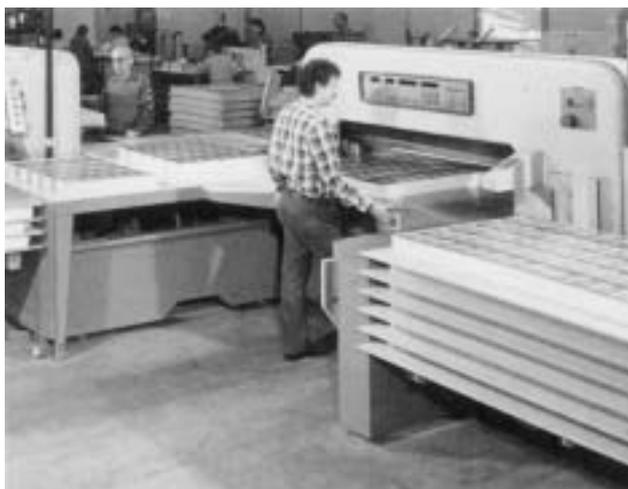
3 Schneideaggregat mit Transporteinrichtung
